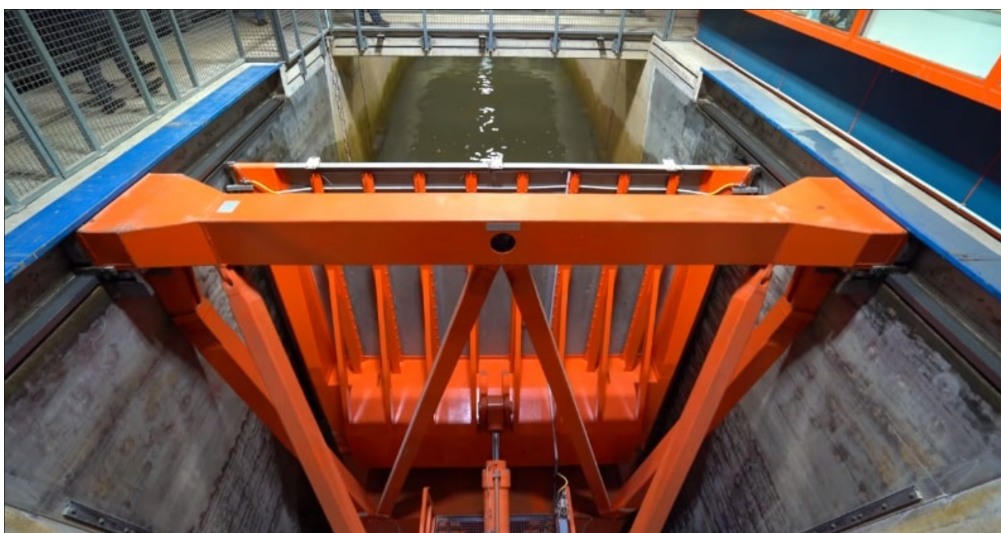
Slika 5: Naprava in bazen, v katerem lahko ustvarimo razbojniške valove. Nahajata se v Hannoveru [15].
