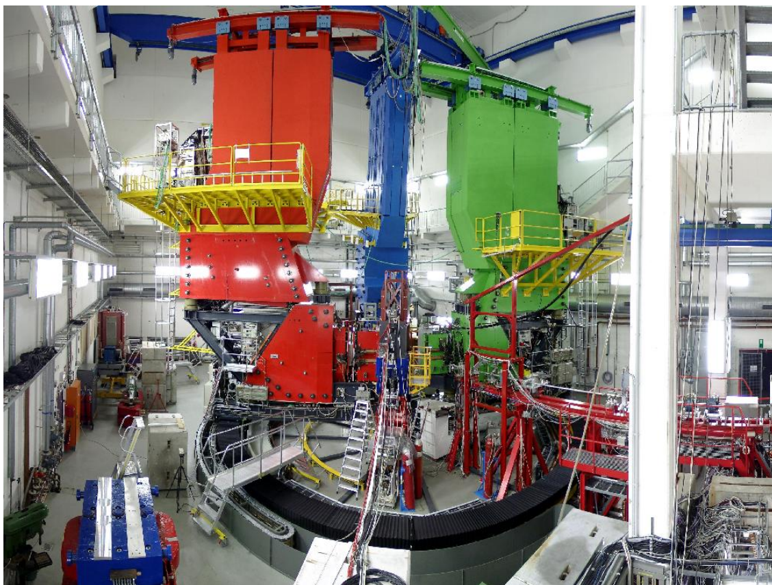
Slika 2. Fotografija dvorane A1 (Mainz) s tremi velikimi spektrometri v rdeči, modri in zeleni barvi (A, B in C) ter manjšim spektrometrom SOS (ang. Short-Orbit Spectrometer ) nameščenim pred tarčo v sredini. Slika je dostopna na spletni strani kolaboracije A1, kjer je eksperiment tudi podrobneje opisan [23].
