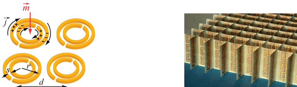
Slika 7. Osnovna in največkrat uporabljena struktura metamaterialov so ti. split ring resonators. Gre za dva neskljenjena obroča, s praznima prostoroma na nasprotnih mestih. Magnetni pretok skozi obroča inducira tok. Na ta način se takšna osnovna struktura obnaša kot efektivni magnetni dipol. Povzeto po [25].
