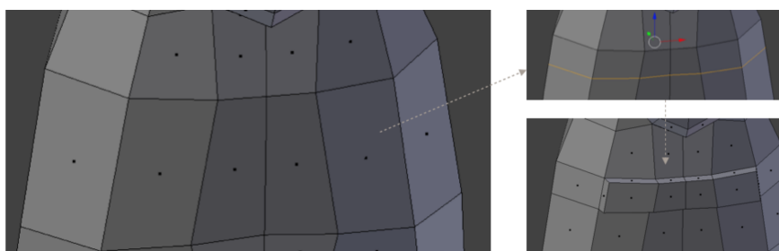
Slika 5. Na levi vidimo sliko dela modela, kjer bi radi dodali neka podrobnosti, na desni zgoraj uporabo operacije reza in na desni spodaj primer dodajanja podrobnosti s pomočjo dodatne geometrije.
