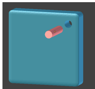
Slika 2. Uporaba operacije NE (razlika množic) na kvadru (kvadru smo izrezali luknjo v obliki valja).
