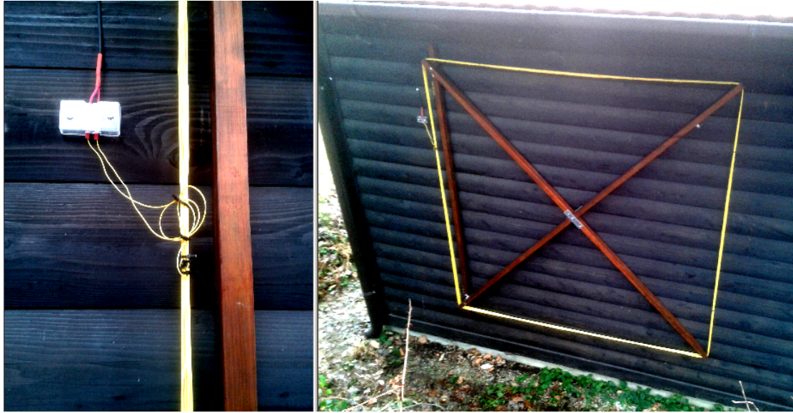
Slika 3. Antena AGO na astronomskem geofizikalnem observatoriju Golovec v Ljubljani. Navita je okoli 2 m širokega lesenega okvirja ter ima 30 navojev. Konca žice sta preko vijačne sponke (na sliki levo) povezana z 9 m dolgim koaksialnim kablom, ki potuje v kontrolno sobo.
