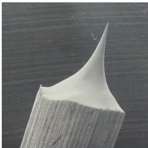
Slika 1. Slika volframove konice, posneta z vrstičnim elektronskim mikroskopom
