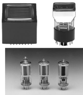
Slika 6. Primeri fotopomnoževalk z različno geometrijo.
