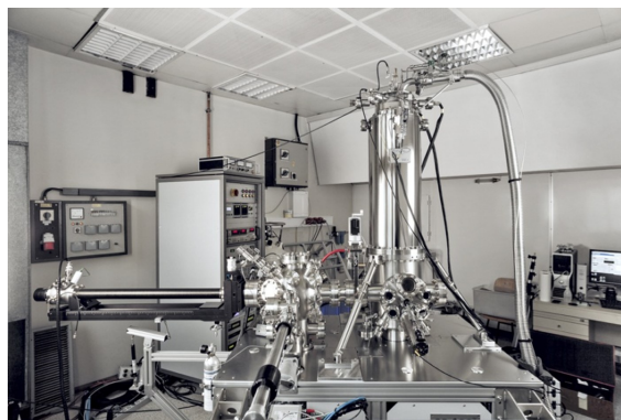
Slika 2. Fotografija postavitve vrstičnega tunelskega mikroskopa na Institutu Jožef Stefan. 1
