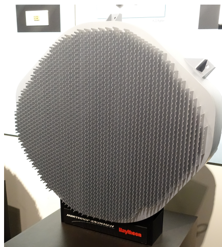
(b) AESA radar, razvit za letalo F-22 Raptor. Vir: [14].
