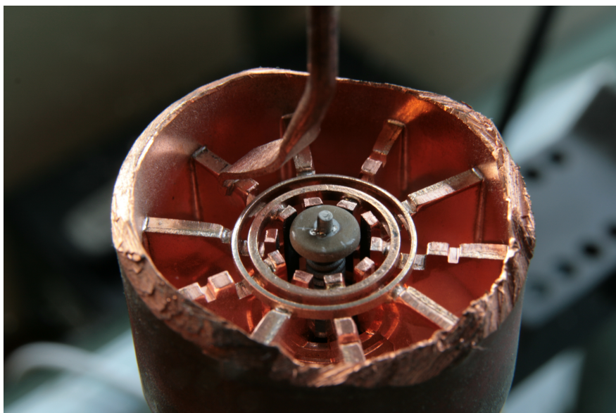
Slika 2. Prerez magnetrona, na vrh sodi še en magnet. Na sredini je katoda, okrog pa votline, ki delujejo kot induktivno-kapacitivni členi. Na eno od sten je priključena antena, ki zaradi sklopitve votlin prejme celotno moč. Vir: [6].
